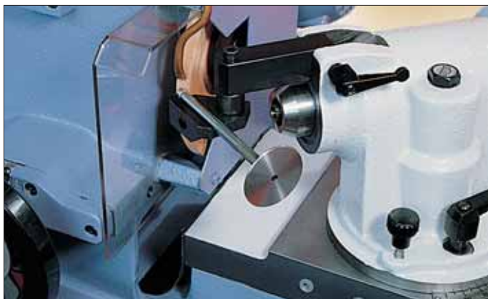
Operazione di smussatura dello stelo/valvola a mezzo di apposito dispositivo. Stem/valve chamfering with chamfering device.
