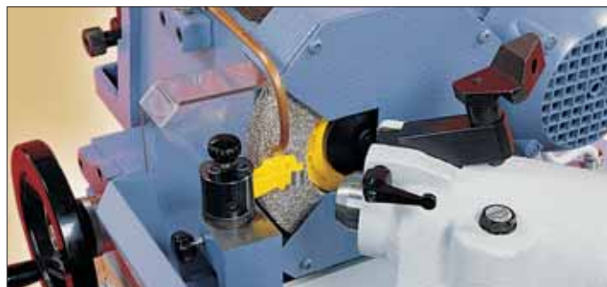
Rettifica, con speciale dispositivo, di un bilanciere per punteria idraulica. Refacing a rocker for a hydraulic tappet with special device.
