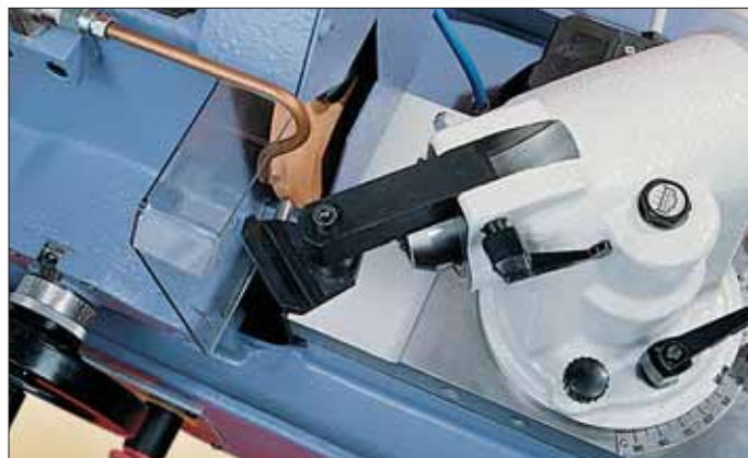
Operazione di ravnivatura della mola con dispositivo universale porta diamante. Wheel dressing with universal diamond holder fitting.
