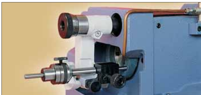
Taratura, mediante calibro, del dispositivo per l'intestatura della valvola. Setting valve butting device with gauge.
