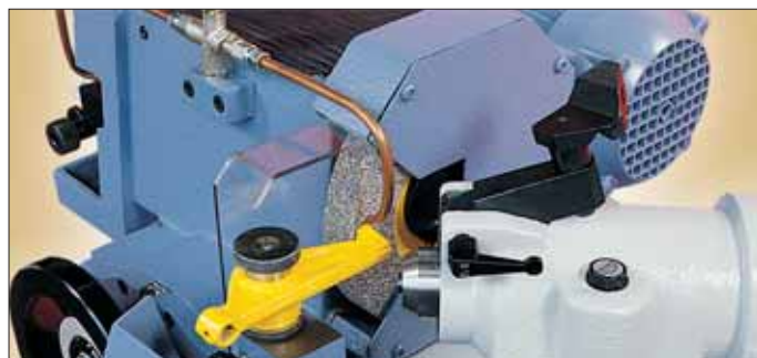
Vista del dispositivo per la rettifica dei bilancieri. View of rocker refacing device.
